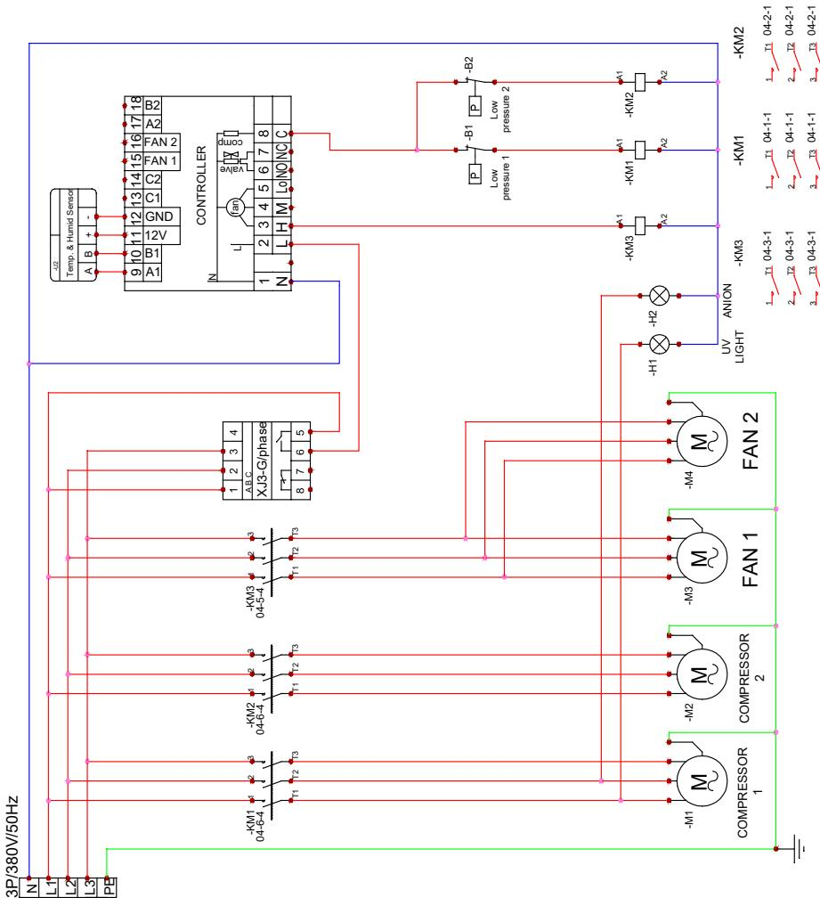
DanVex DEH-5K DEHUMIDIFIER WIRING DIAGRAM
