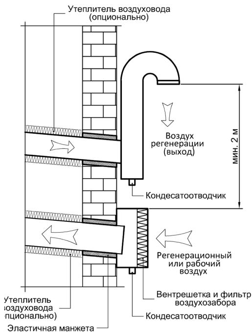
Если в осушитель воздух забирается снаружи, воздухозаборник, чтобы предотвратить всасывания пыли и мусора, должен располагаться достаточно высоко над землей или об оборудован дополнительным фильтром на входе. Вход должен находиться вдали от возможных источников загрязнения, таких как выхлопы отработанных газов, пар и вредные газы.
