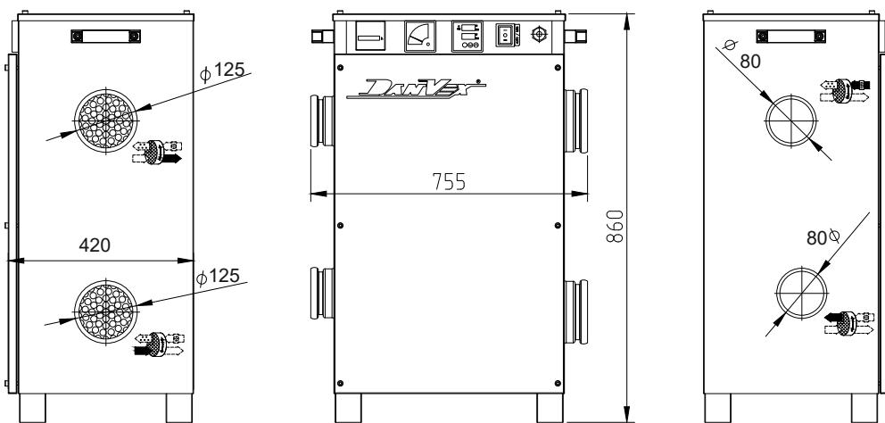
**Рис 2. Размеры осушителя воздуха AD-550**
